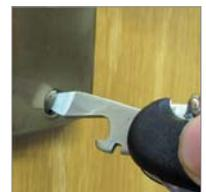
Wie das Modell 2609 ist auch dieses Messer mit einer großen Klinge, einem Korkenzieher, einem Flaschenöffner, einem Büchsenöffner, einer Ahle und einem Schraubendreher ausgestattet.
